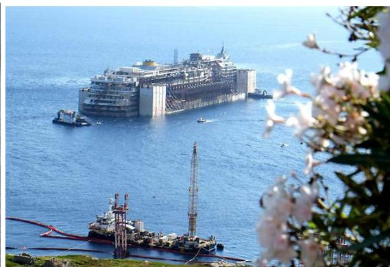
***Costa Concordia in fase di galleggiamento con i cammelli a sviluppo verticale per stabilità longitudinale.***
